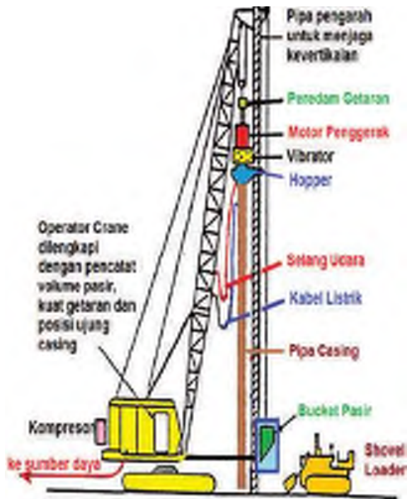
Gbr. 19. Peralatan Vibro-Kompaksi bila digunakan Material Pengisi.
